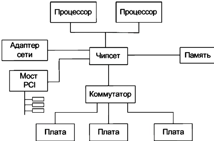
Рис. 20. Архитектура, содержащая коммутатор PCI Express
