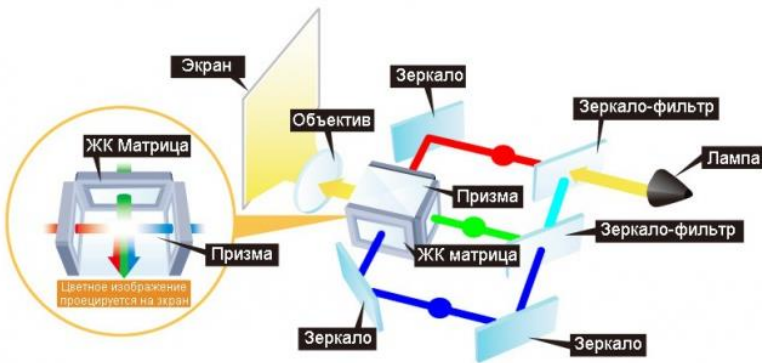
Рис. 9 Принцип работы 3LCD проекторов
